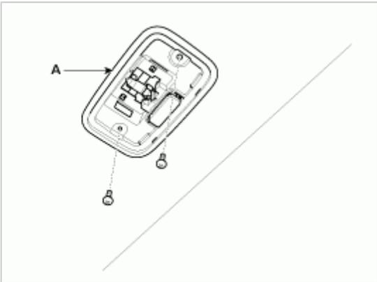
4. 分离连接器(A)后, 拆卸室内灯(B)。
